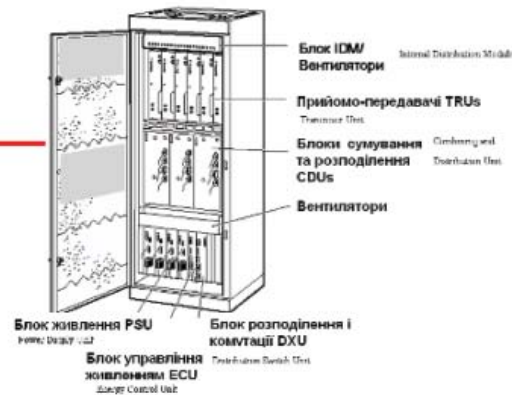
Мал.5 Внутрішній вигляд технологічного контейнера
